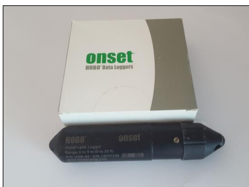
รูปที่ 4-26 เครื่องวัดระดับน้ำ HOBO
