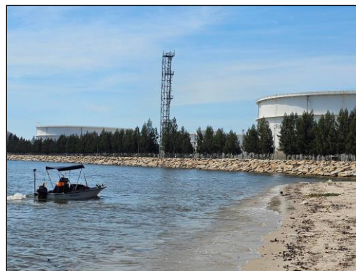
รูปที่ 4-34 การสำรวจระดับความลึกพื้นที่ท้องทะเลด้วยระบบ AUTOMATION
