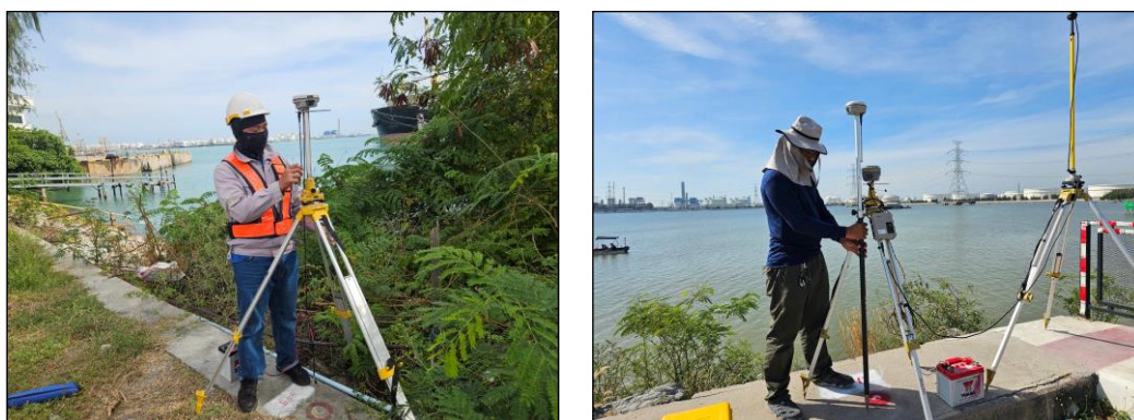
รูปที่ 4-31 การสอบเทียบค่าพิกัดของ GNSS (ROVER)
