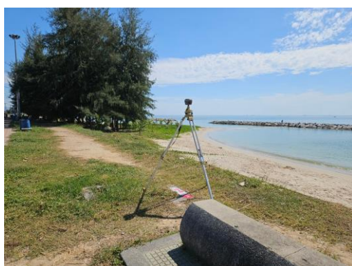
รูปที่ 4-28 การรังวัดค่าพิกัดและค่าระดับด้วยเครื่องรับดาวเทียม GNSS-STATIC ฝั่งตะวันออก
