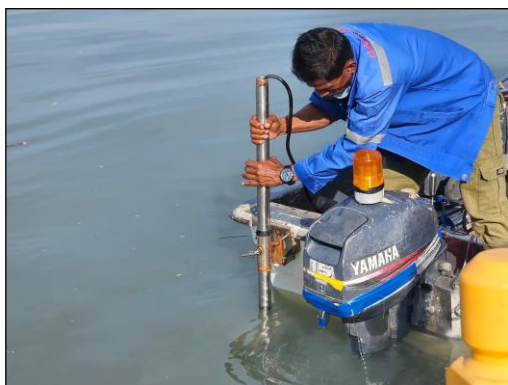
รูปที่ 4-35 ติดตั้งเสาอากาศ GNSS บริเวณท้ายเรือตำแหน่งเดียวกับหัวส่งเครื่องหยั่งน้ำ
