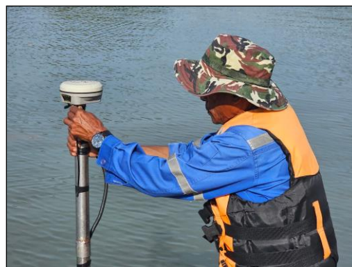
รูปที่ 4-35 ติดตั้งเสาอากาศ GNSS บริเวณท้ายเรือตำแหน่งเดียวกับหัวส่งเครื่องหยั่งน้ำ
