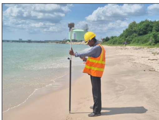
รูปที่ 4-24 เครื่องหาพิกัดระบบ GNSS ใช้สำหรับหาตำแหน่งพิกัดบนฝั่งและในเรือสำรวจ
