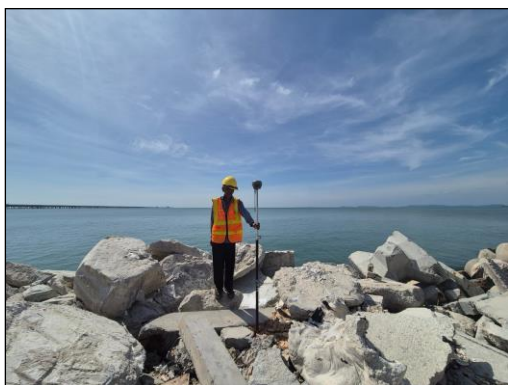
รูปที่ 4-32 สำรวจค่าระดับชายฝั่งด้วย GNSS แบบ RTK
