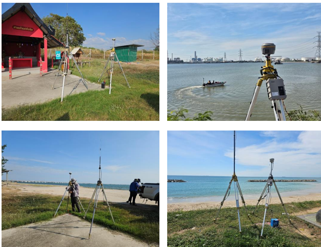
รูปที่ 4-30 ตั้งสถานี GNSS RTK BASE STATION ที่หมดควบคุมโครงการ
