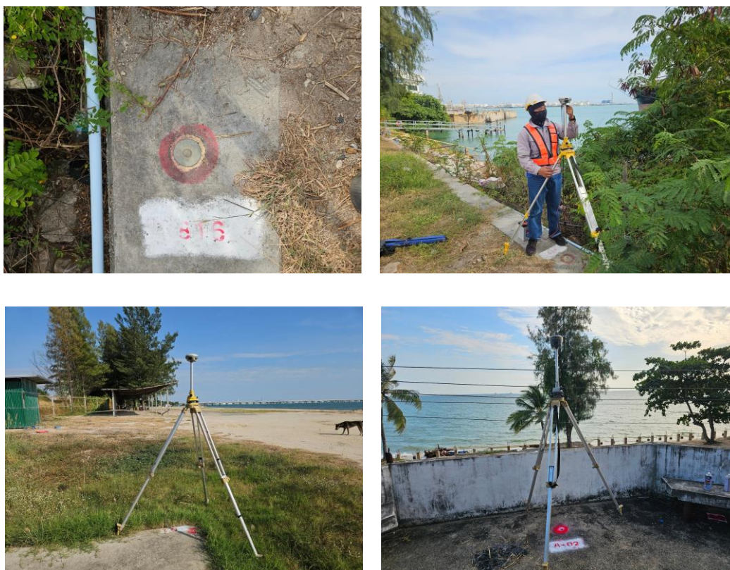
รูปที่ 4-29 (ต่อ) การรังวัดค่าพิกัดและค่าระดับด้วยเครื่องรับดาวเทียม GNSS-STATIC ฝั่งตะวันตก
