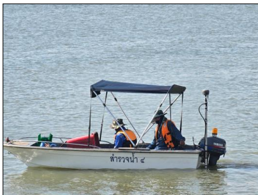
รูปที่ 4-34 การสำรวจระดับความลึกพื้นที่ท้องทะเลด้วยระบบ AUTOMATION
