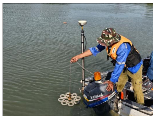
รูปที่ 4-37 ตรวจสอบค่าความลึกด้วยการทำบาร์เช็ค
