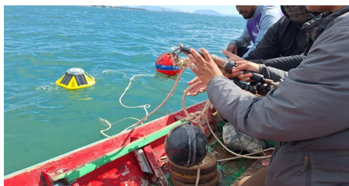
รูปที่ 4-14 ภาพถ่ายระหว่างการติดตั้งเครื่องมือตรวจวัดความเร็วและทิศทางกระแสน้ำที่ระดับกลางความลึกน้ำ ด้วยเครื่อง Electromagnetic current meter บริเวณชายฝั่งนิคมอุตสาหกรรมมาบตาพุด อ.มาบตาพุด จ.ระยอง
